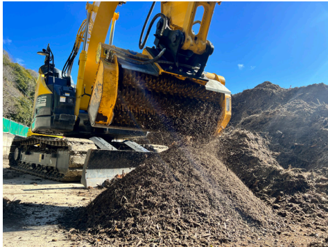
TM クラッシャーにて破碎した根っこをギルスタースクリーンにてふるいをかけます
