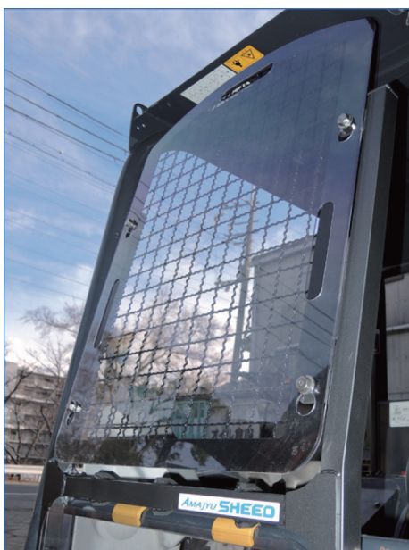
【5】より防護機能を高める金網タイプとの併用も可能です。（透明、スモークタイプどちらも併用可）
