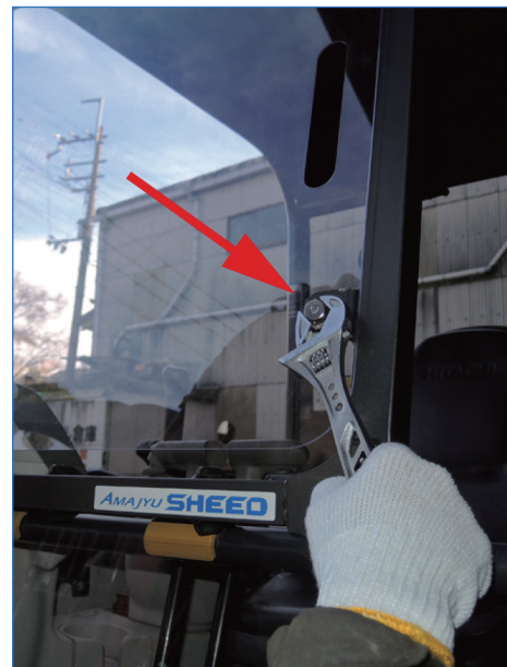
【3】17mm スパナ等で PC パネルを十分に締め付けます。
