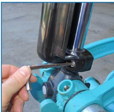
④ ボディ部をロッドにセットして同梱の工具でボルト、ナットをしっかりと締め付けます。
