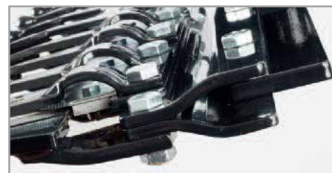
■ 刃物の脱着が容易（ボルト固定）
